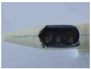
Die Rumpfhälften sind gut ausgeformt und erst mal ohne Verzug gegossen. Sie liegen als Hälften plan und eben auf. Wobei der vordere Konus, der die Radarabdeckung darstellt, beim zusammen anpassen nicht komplett rund ausgeführt ist und aufwendig nachgearbeitet werden muss.
