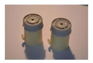
Die Propellerblätter und die Kleinteile sind sehr genau abgegossen und es Bedarf großer Vorsicht sie von den Angussblöcken zu befreien. Die Propellerhauben sind maßlich nicht korrekt und sollten durch andere Bauteile ersetzt werden. Außerdem sind sie im Vollguss ausgeführt und müssen erst plangeschliffen und ausgebohrt werden. Die Positionslöcher der Propellerblätter 3 x 120° Grad und die Tiefe sowie der Durchmesser der Bohrungen sollten genau ermittelt und angezeichnet werden.
