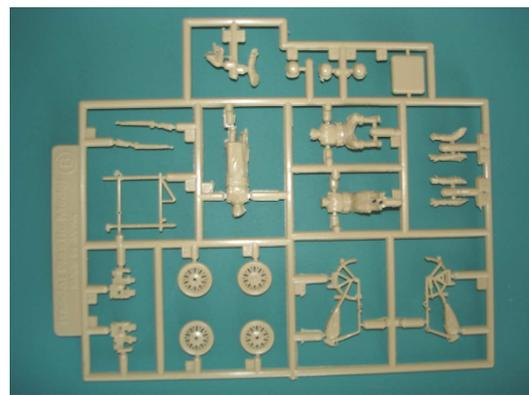
Die Passgenauigkeit der einzelnen Teile muss noch geprüft werden, macht aber schon jetzt am Gussast einen guten Eindruck. Die Anspritzpunkte der Einzelteile sind klein und wenig auffällig.
