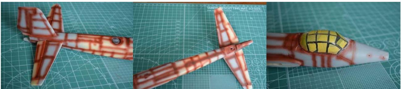
Nach dem Trocknen der Mahagonyfarbe kommt auf die Oberseite der Flügelteile und der Rumpfoberseite in die Mitte der meisten grau grundierten Beplankungen eine verdünnte weiße Emailfarbe. Diese wird schon jetzt aufgetragen, um bei den anschließenden Lackierung die einzelnen Felder schon durchscheinend darzustellen.
